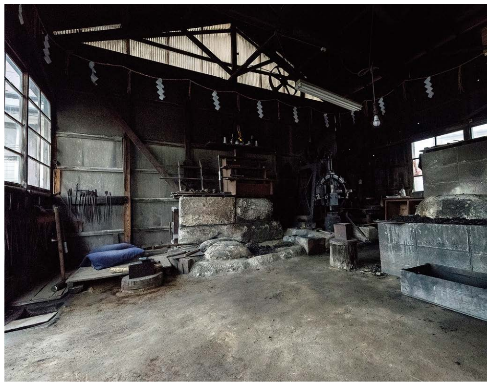
昔ながらの作業場。刀鍛冶の作業の中でも焼き入れをする際は 鉄の色を見極めるため、月のない夜に行なわれる。
