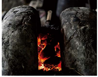
(写真・上) 松炭の火をおこしたら火床に移して温度を調整する。 (写真・中) 1200℃位まで熱せられた玉鋼。これを叩く。 (写真・下) フイゴで火の勢いを上げ、玉鋼を熱していく。
