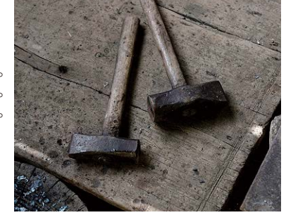
(写真・上) 鑄などの形状を打ち出す小鋸。かなりの重量がある。 (写真・中) 沸かした玉鋼を載せる金床。 (写真・下) 着火させるときに使う鉄の棒。
